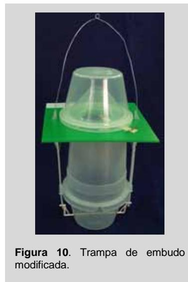
Figura 10. Trampa de embudo modificada.
